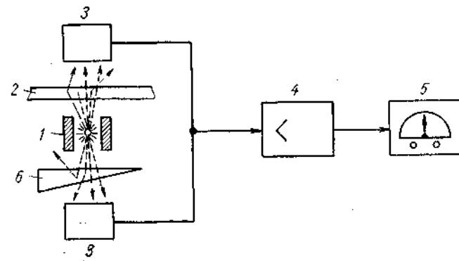
Рис. 64. Дифференциальная схема измерения толщины:
