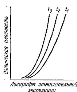
Рис. 24. Влияние времени проявления  $t$  рентгеновской пленки на положение ее характеристической кривой  $t_3 > t_2 > t_1$ .
