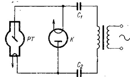
Рис. 9. Схема удвоения напряжения с одним кенотроном.
