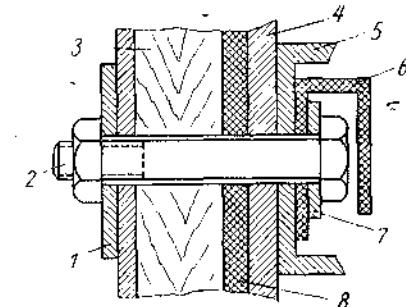
Рис. 71. Закрепление дверных стяжек болтами:
