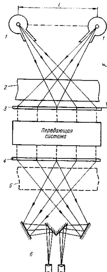
Рис. 60. Схема образования стереоскопического изображения контролируемого изделия в стереотелевизионном дефектоскопе:
