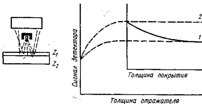
Рис. 67. Измерение лакового покрытия на металле.
