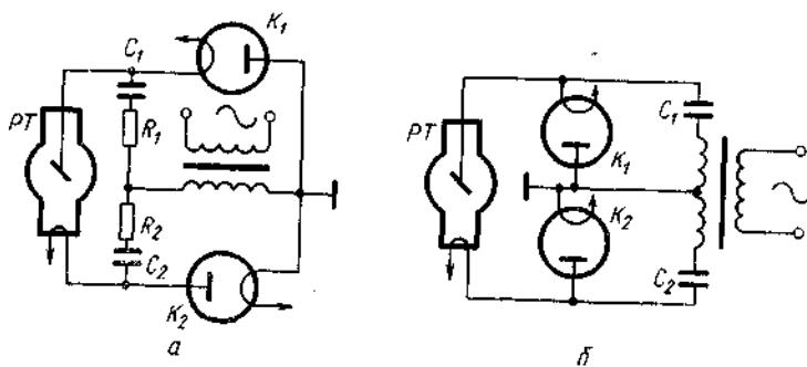
Рис. 10. Схемы удвоения напряжения с двумя кенотронами:
