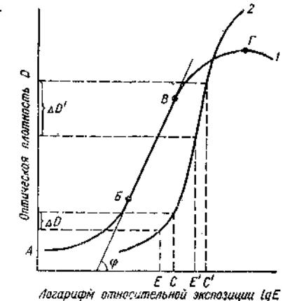
Рис. 22. Характеристические кривые двух рентгеновских пленок.
