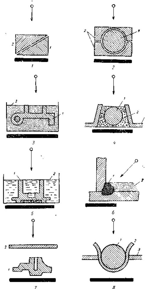
Рис. 37. Схема применения компенсаторов в радиографии:
