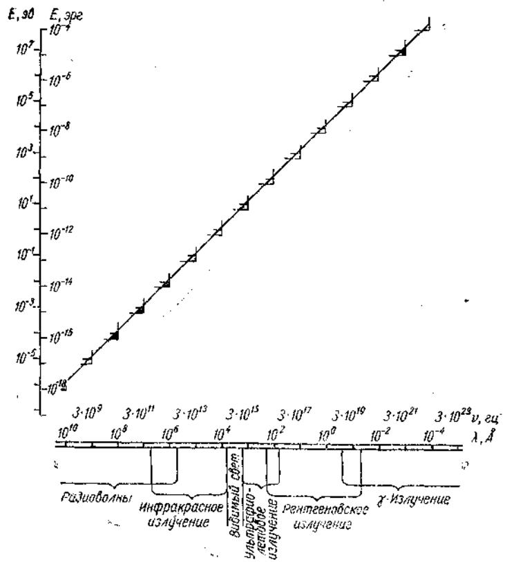
Рис. 1. Шкала различных электромагнитных излучений и nomogramma перевода длины волны (частоты) излучения в энергию, выраженную в эргах или электронвольтах (1 эв =  $1,602 \cdot 10^{-12}$  эрг).
