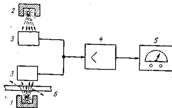
Рис. 65. Балансный метод измерения толщины:
