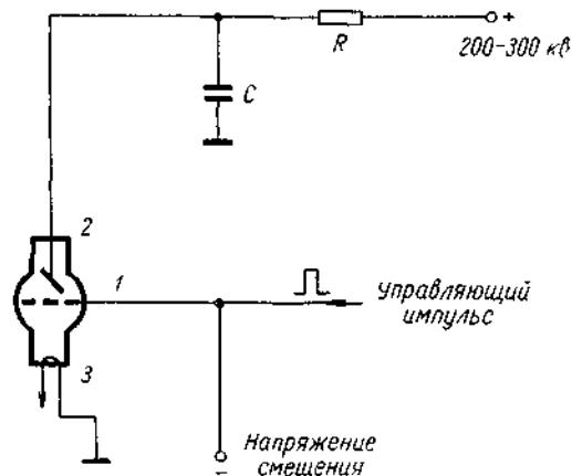
Рис. 12. Схема импульсной рентгеновской трубки:
