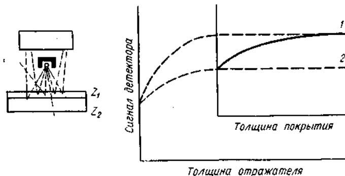
Рис. 68. Измерение толщины оловянного покрытия на жести.
