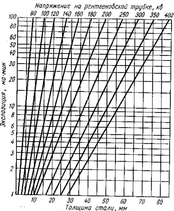
Рис. 38. Номограмма для определения экспозиций просвечивания сплавов на основе железа на пленку РТ-1 (фокусное расстояние 75 см,  $D=1,3-1,5$ ) с оловянно-свинцовыми фольгами толщиной 0,05 мм рентгеновским излучением.
