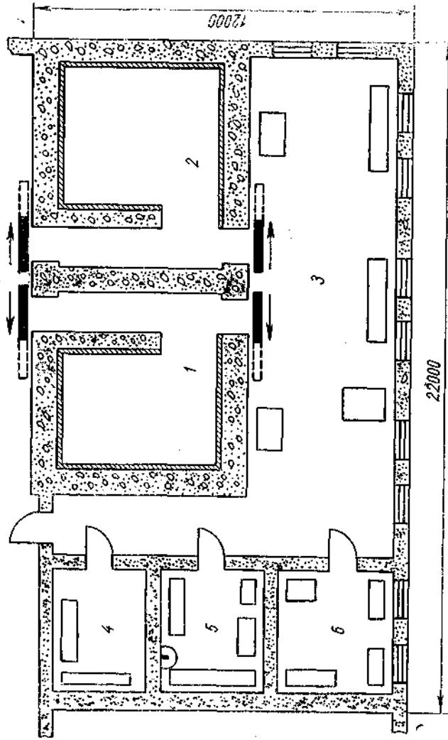
Рис. 74. Гамма-дефектоскопическая лаборатория в литейном цехе:
