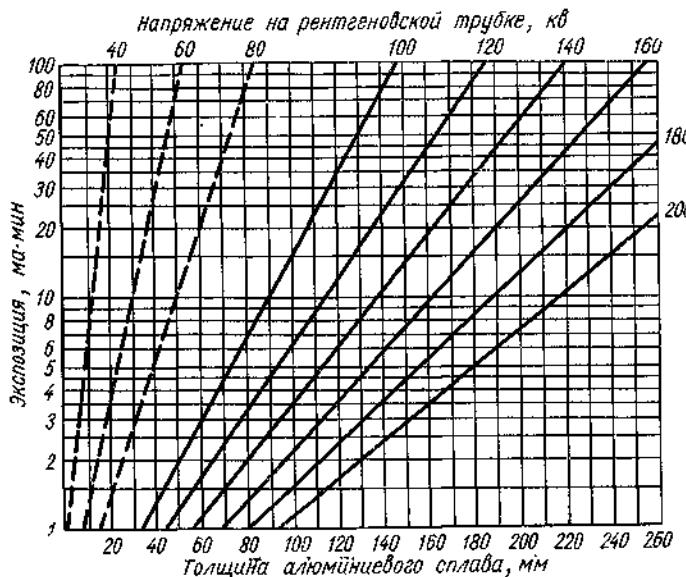
Рис. 40. Номограмма для определения экспозиций просвечивания алюминиевых сплавов на пленку РТ-1 (фокусное расстояние 75 см,  $D=1,3-1,5$ ) рентгеновским излучением:
