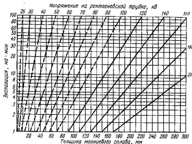
Рис. 41. Номограмма для определения экспозиций просвечивания магниевых сплавов на пленку РТ-1 (фокусное расстояние 75 см.  $D=1,3-1,5$ ) рентгеновским излучением.
