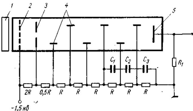
Рис. 5. Схема включения фотоумножителя:
