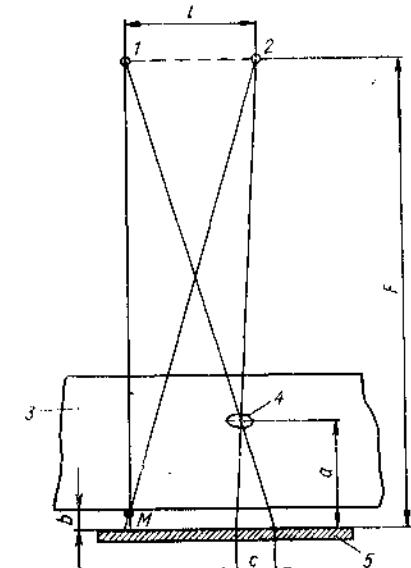
Рис. 54. Схема определения глубины залегания дефекта:
