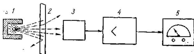
Рис. 63. Схема измерения толщины материала по ослаблению излучения:
