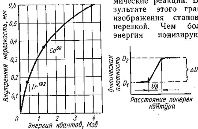
Рис. 30. Зависимость внутренней нерезкости пленок от энергии излучения.
