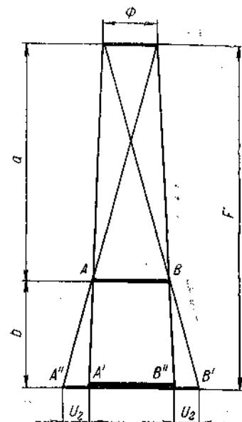
Рис. 31. Схема образования геометрической нерезкости.
