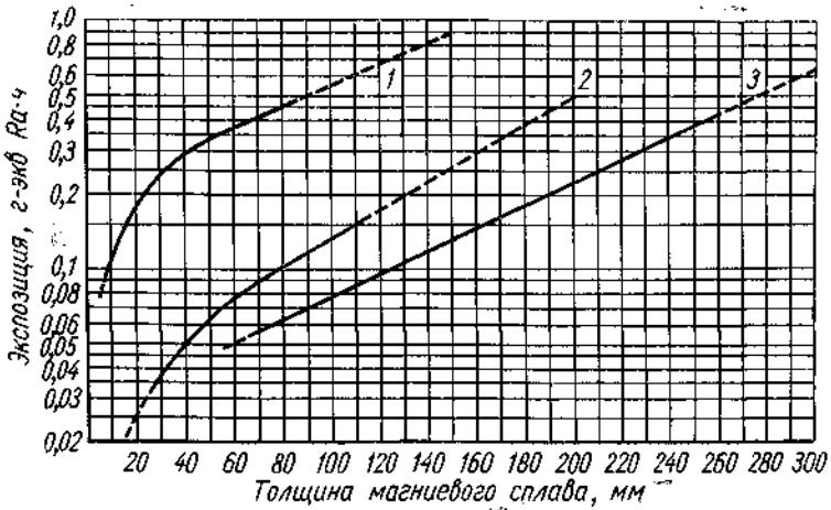
Рис. 45. Номограмма для определения экспозиций просвечивания магниевых сплавов на пленку РТ-1 ( $D=1,5$ )  $\gamma$ -излучением радиоактивных изотопов:
