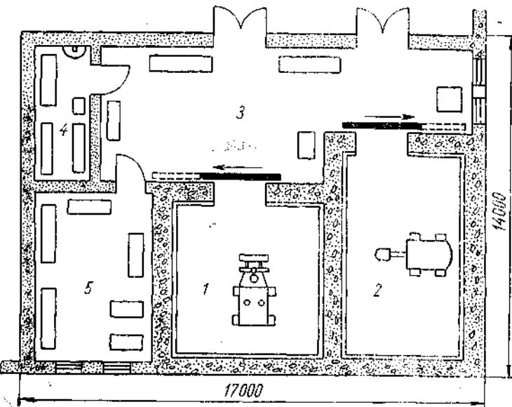
Рис. 73. Рентгеновская лаборатория в сварочном цехе:
