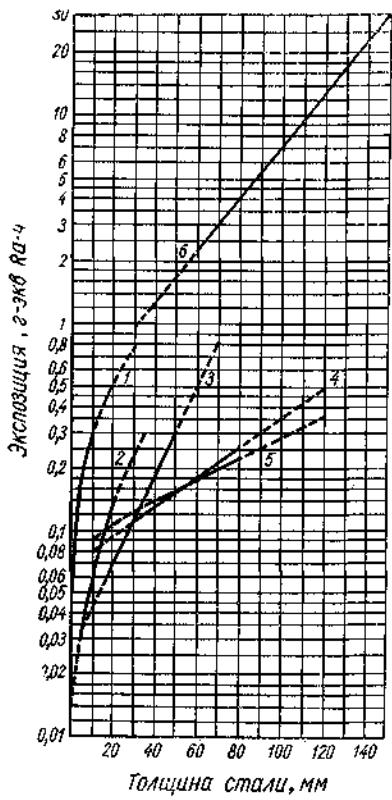
Рис. 42. Номограмма для определения экспозиций просвечивания сплавов на основе железа на пленку РТ-1 ( $D=1,5$ )  $\gamma$ -излучением радиоактивных изотопов:
