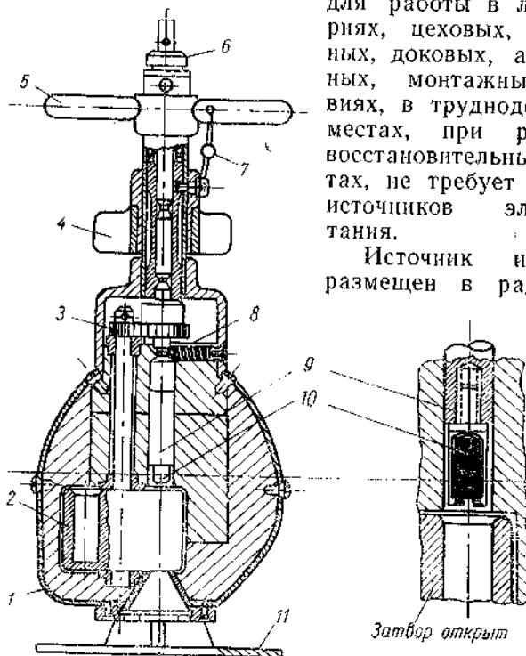
Рис. 21. Схема защитного контейнера ГУП-Іг-5-2 с механизмом открывания затвора:
