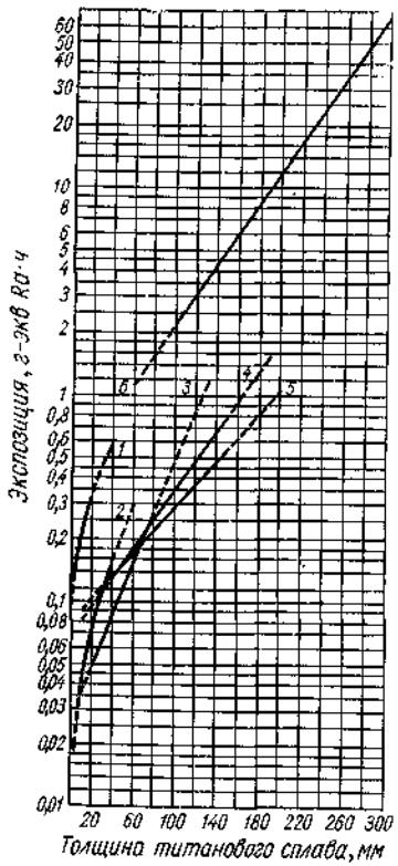
Рис. 43. Номограмма для определения экспозиций просвечивания титановых сплавов на пленку РТ-1 ( $D=1,5$ )  $\gamma$ -излучением радиоактивных изотопов:
