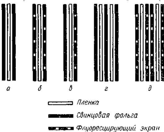
Рис. 27. Способы зарядки кассет:
