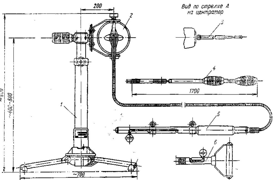
Рис. 20. Общий вид гамма-аппарата ГУП-Ир-5-2:
