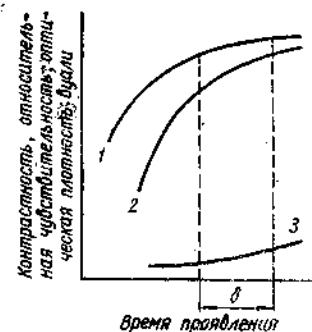
Рис. 25. Зависимость контрастности (среднего градиента) пленки (1), относительной чувствительности пленки (2) и оптической плотности вуали (3) от времени проявления пленки;  $\delta$  — область нормального времени проявления.
