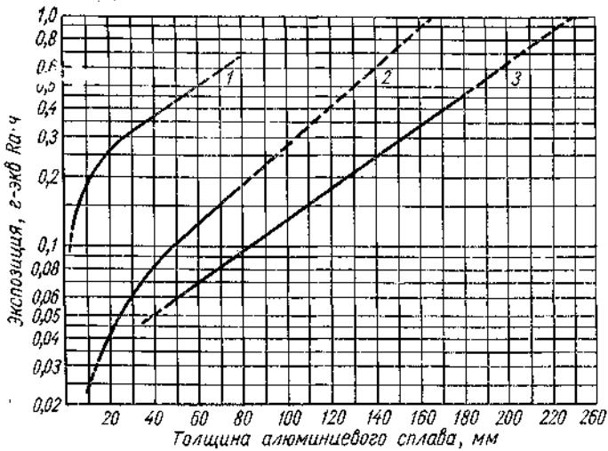
Рис. 44. Номограмма для определения экспозиций просвечивания алюминиевых сплавов на пленку РТ-1 ( $D=1,5$ )  $\gamma$ -излучением радиоактивных изотопов:
