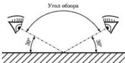
Рис. 2. Схема проведения визуального контроля
