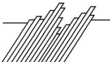
Рис. 91. Линии скольжения, вызванные циклическим нагружением (в сечении)
