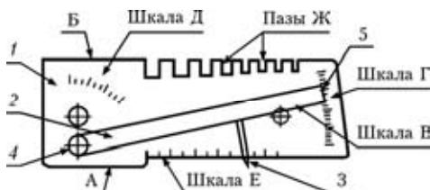
Рис. 68. Универсальный шаблон сварщика типа УШС-3
