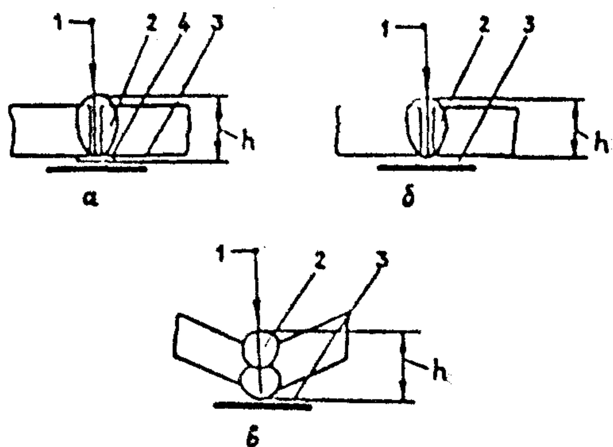
Рис.2. Схемы контроля (а-и) прямолинейных и близких к прямолинейным сварных соединений: 1-источник излучения; 2-контролируемый участок; 3-кассета; 4-подкладная планка;  $h$  - радиационная толщина
