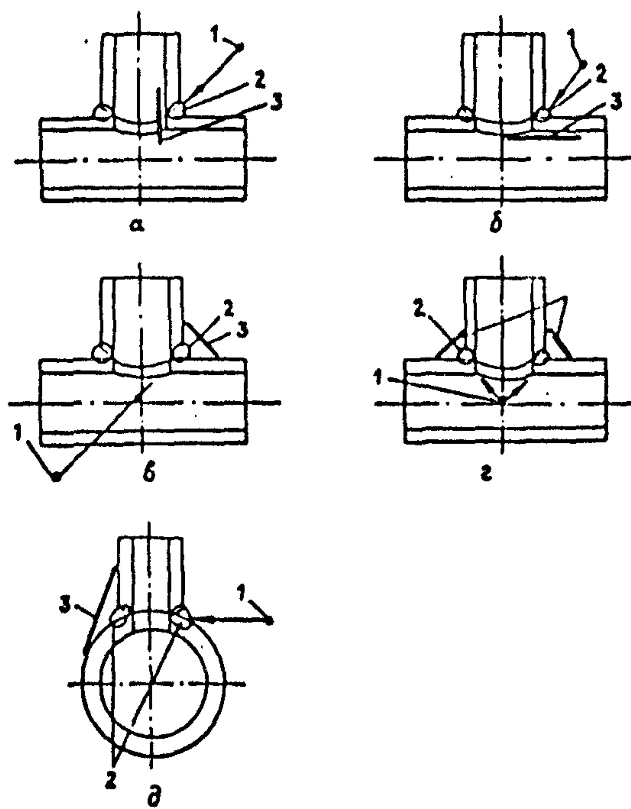
Рис.4. Схемы контроля сварных соединений вварки штуцеров:
